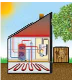
Schéma avec chaudière murale à granulés de bois THERM, ballon E.C.S., installation solaire, réservoir à granulés de bois à l'air libre, circuit de chauffage et eau chaude sanitaire
