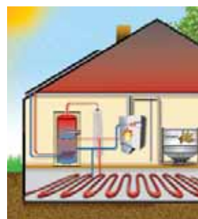
Schéma avec chaudière murale à granulés de bois THERM, système ballon tampon, installation solaire, réservoir à granulés de bois intérieur, circuit de chauffage et eau chaude sanitaire
